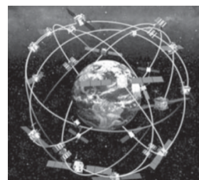
El GPS usa satélites para calcular tu posición en la tierra.
